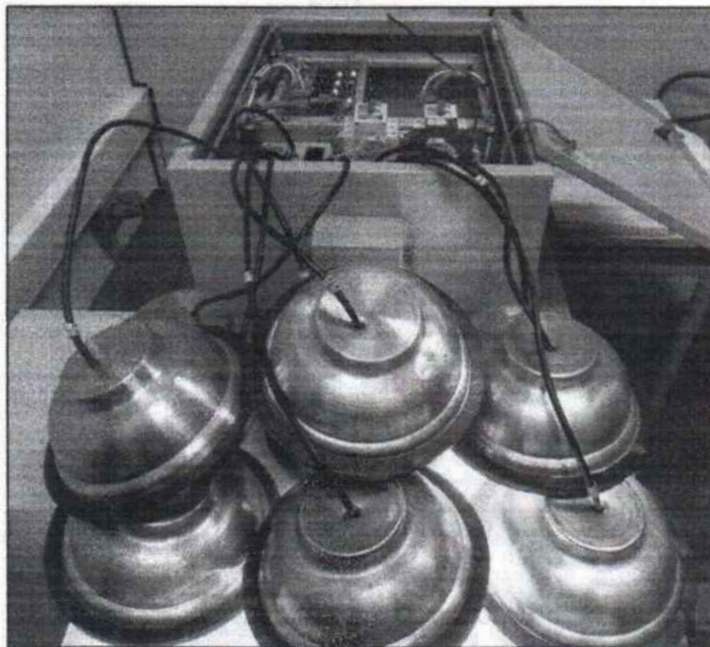
Figura 11- Semáforo Veicular durante a realização do teste de Imunidade a Surtos.
