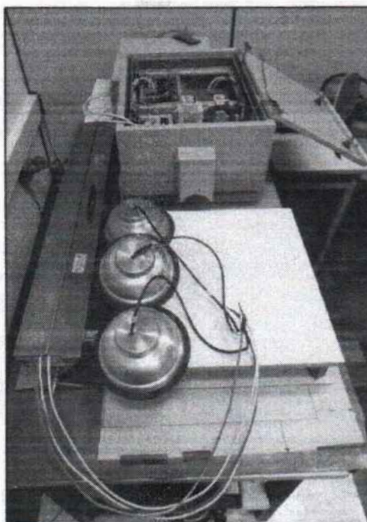
Figura 12- Setup para Realização do teste de Imunidade EFTB acoplado.
